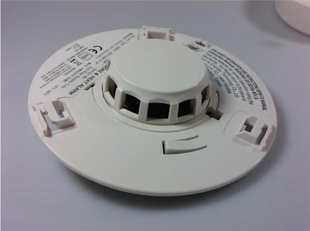
Bild 11 / Abdeckung der Rauchmesskammer /
