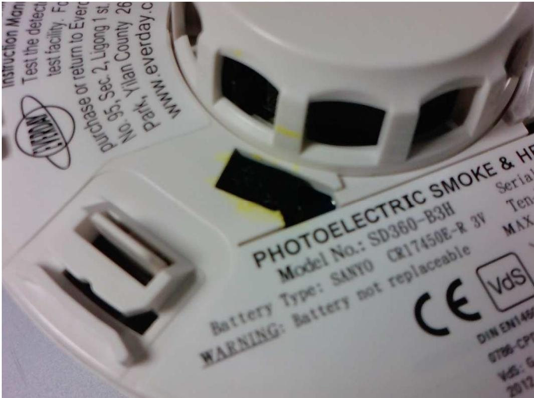
Bild 17 / Fett am Ein- / Aus-Schalter, unbedingt erforderlich für die Korrosionsbeständigkeit /
