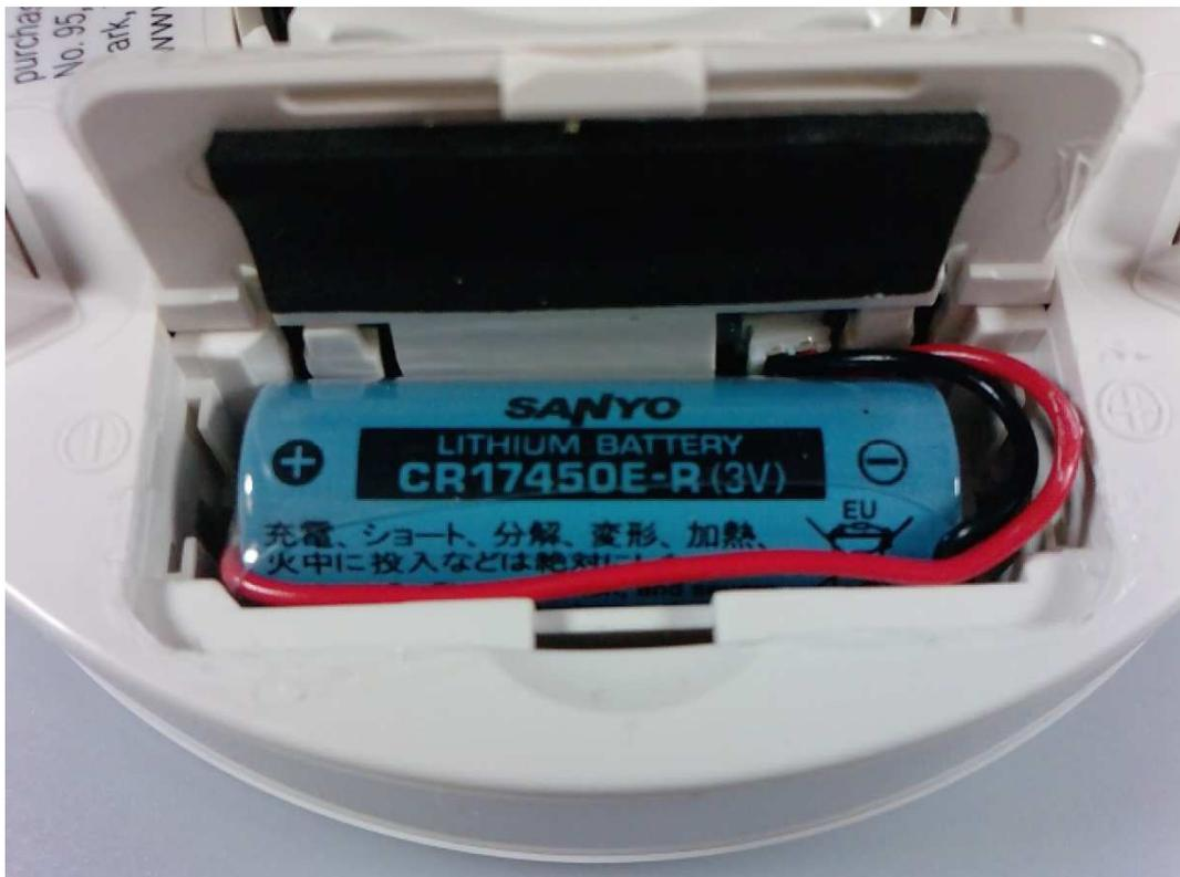
Bild 6 / Picture 6 Batterie, nicht auswechselbar / Battery, not replaceable
