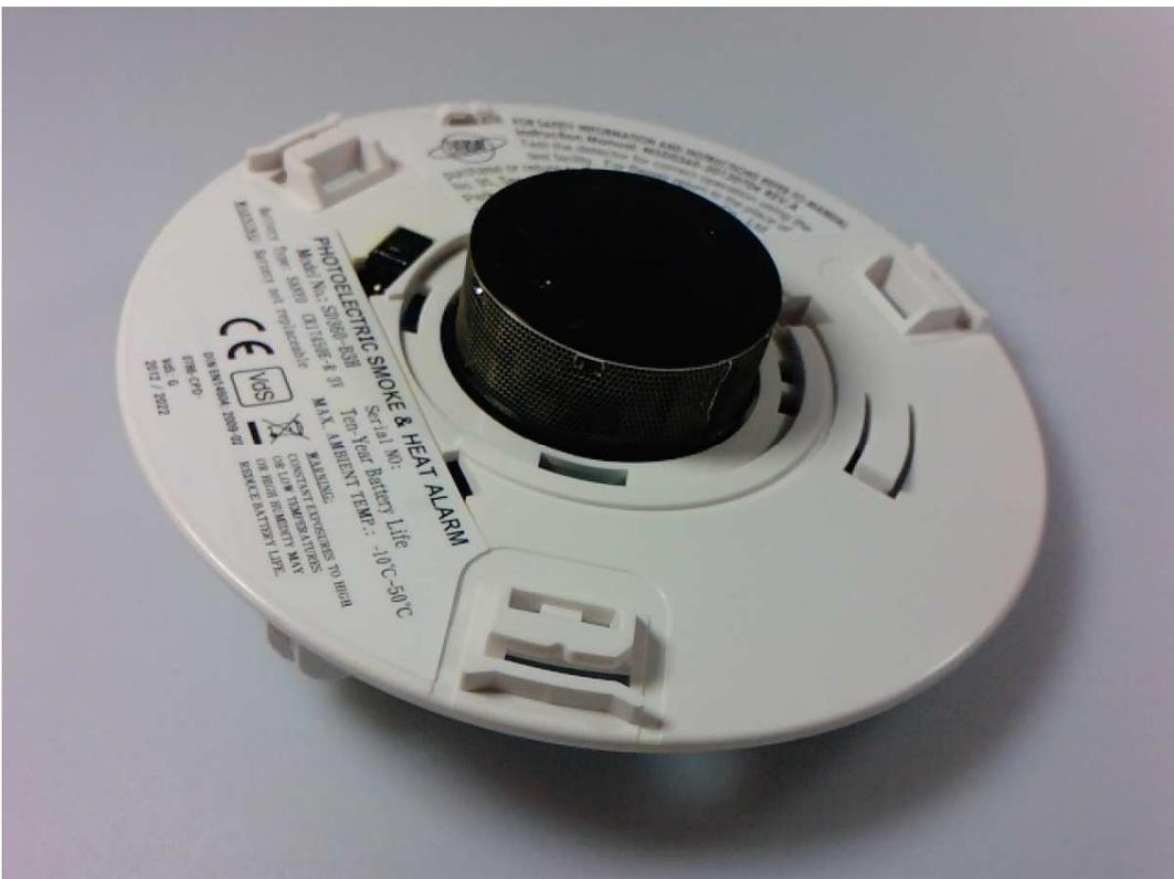
Bild 12 / Abdeckung der Rauchmesskammer abgebaut /
