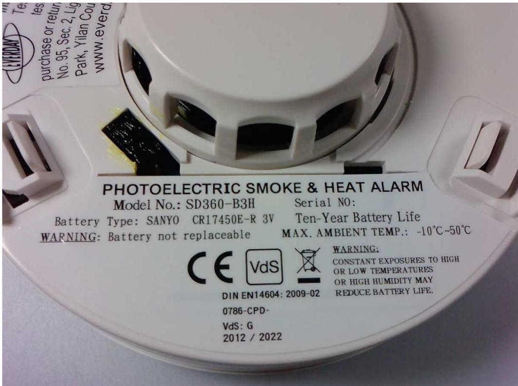
Bild 5 / Picture 5 Typenschild auf der Batteriekappe / Label on battery lid
